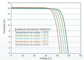
**I-V/P-V Curva con Diferente Irradiación (620W)**
